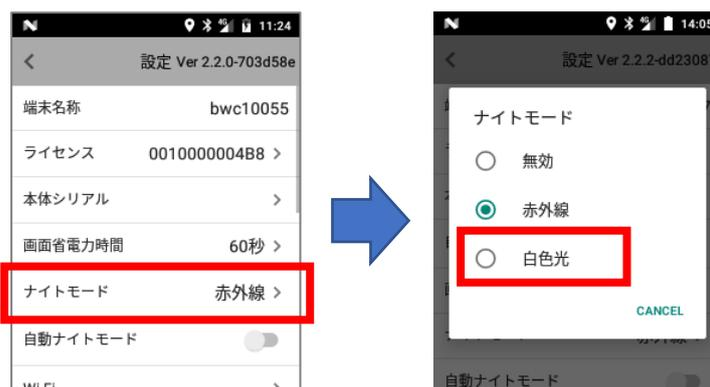
白色光ライトが選択されている場合は、画面に向かって右側面にある□部分のナイトモード ボタンを押下し、手動でナイトモードの ON/OFF 切り替えを行います。
