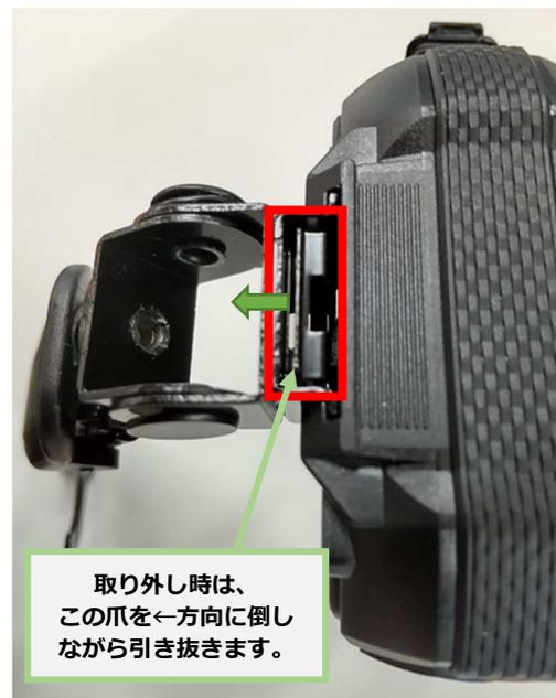
取り外し時は、この爪を←方向に倒しながら引き抜きます。
