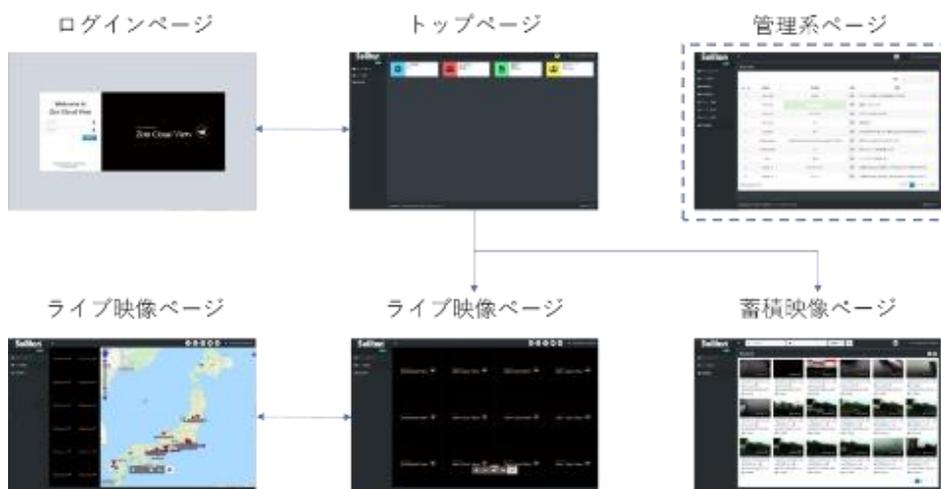
図 13 一般ユーザーページ遷移概要（通常動作）
